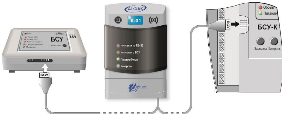
Рисунок 2 – Способ подключения конвертера к БСУ (БСУ-К)
